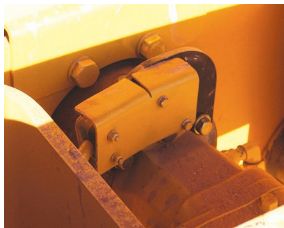
Акселерометры измеряют реакцию грунта на удары вибрационного вальца
