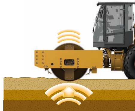
Материал вибрирует в ответ, что обнаруживается и измеряется акселерометром
