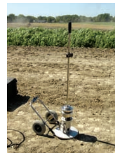
Легкий дефлектометр с падающим грузом
