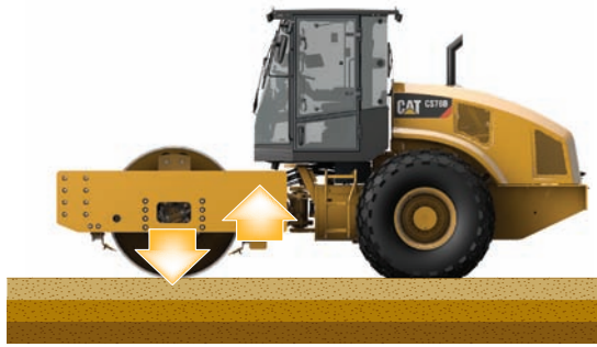
Резонанс ослабляет уплотняющее воздействие
