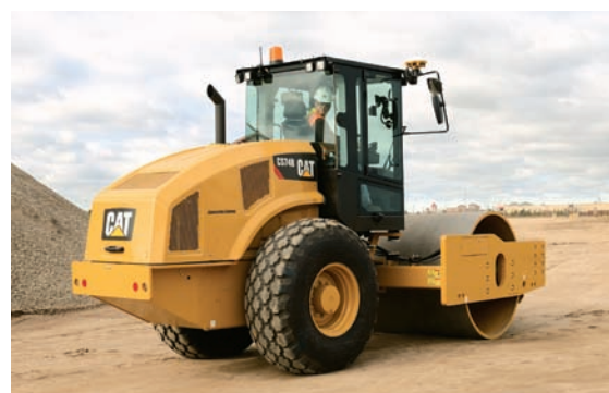
Машинная система измерения уплотнения выдает прогноз или показатель жесткости грунта
