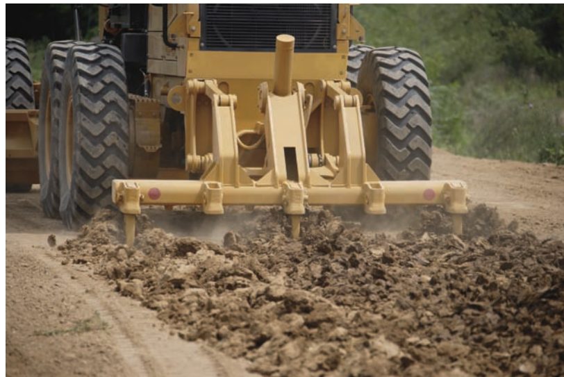
Когда влажность слишком высока, рыхление грунта повышает скорость его осушения
