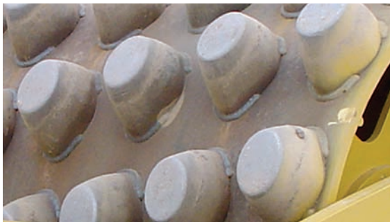
Овальные кулачки хорошо подходят для связных грунтов и слоев увеличенной толщины
